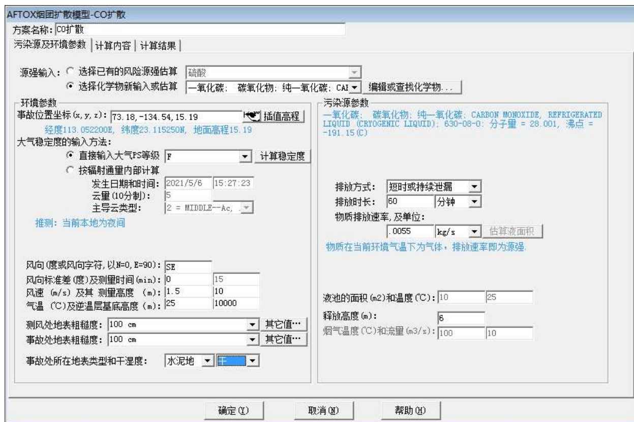
图 5.7-2 最不利气象条件下, 火灾爆炸次生污染物 CO 扩散事故污染源及环境参数输入截图
